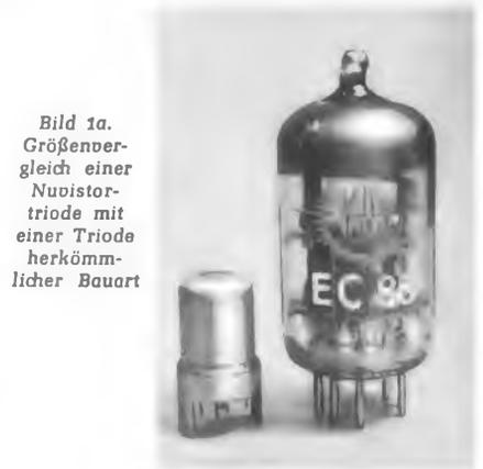
Bild 1a. Größenvergleich einer Nuvistortriode mit einer Triode herkömmlicher Bauart
