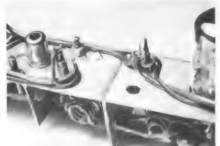
Bild 5. Blick auf das Chassis mit Nuvistor, Anodenkreistrimmer und Durchführungskondensatoren für die Spannungszuführung
