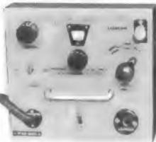
Frequenzbereich 100 Kc — 30 Mc; Doppelquarz 100 Kc + 1000 Kc; VFO-Regelbereich 100 Kc; Eichkontrolle des VFO's durch 100 Kc Quarz + Nullpunktcorr.; Ablesegenauigkeit in den Grundwellenbereichen besser als 1 Kc.
