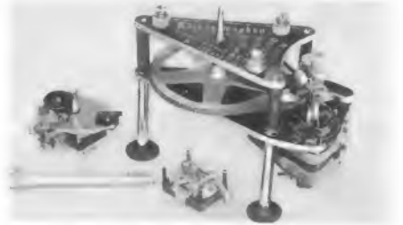
Bild 2. Albert Ebner, von 1936 an Teilhaber von Perpetuum, baute diesen ersten serienmäßigen elektrischen Plattentellerantrieb im Jahre 1921. Davor Beispiele heutiger Technik: links ein Antrieb mit vierpoligem Spaltpol-Motor und vorn in der Mitte der eigentliche Motor
