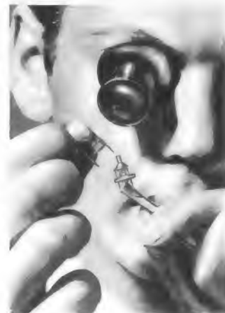
Bild 2. So klein ist der Nuvistor
