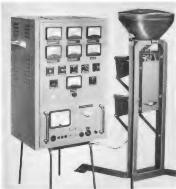
Bild 4. Bildröhren-Prüfgerät für größere Werkstätten (Modell STT 500 der NEV)
