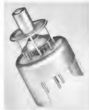
Bild 1. Konzentrisches System der Nuvistor-Triode Valvo 7586 (Stahlblechkolben oberhalb der Trägerplatte entfernt)
