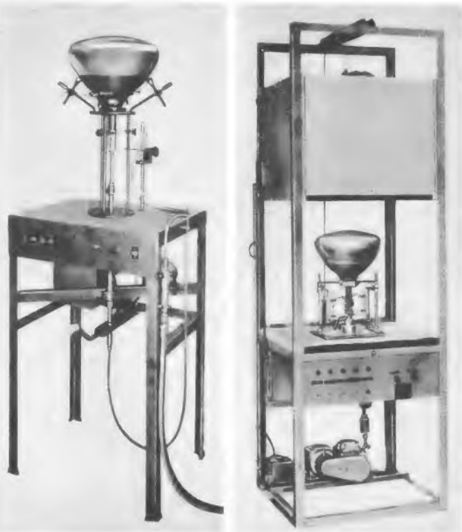
Bild 2. Halbautomatischer Arbeitstisch für das Anschweißen des neuen Röhrenhalses mit eingesetztem neuem System (Modell AWS 400 der NEV)
