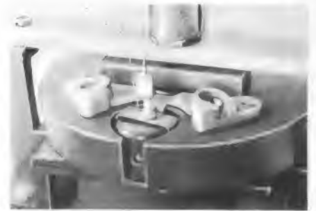
Bild 20b. Spulensystem mit Spiegel, Torsionsdraht und zweitem Draht zur Strom-Rückleitung
