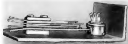
Bild 2. Die Schalt-Normbuche, zusammgebaut aus einer Normbuche und dem Kontaktfedersatz eines alten Kellgsschalters
