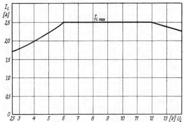
Bild 5. Belastungsdiagramm des Speisegeräts gemäß Bild 3
