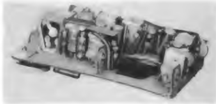
Bild 3. Bestückte Schaltungsplatte mit Halterungen für zwei Kleinstzellen (toorn) und der Ausnehmung für den Lautsprecher
