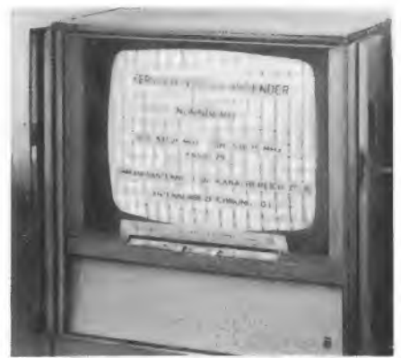
UHF-Testbild des Fernseh-Versuchssenders Nürnberg auf dem Grundig-Zauberspiegel 59 S 50. Antenne: UHF-Behelfszimmerantenne. Entfernung: über 20 km. – Zwischen dem Sender und dem Empfangsort liegen umfangreiche Gleisanlagen der Bundesbahn und hohe Gasometer. Der Empfänger steht in einem vom Sender abgewandten Raum eines Stahlbetonbaus mit Aluminiumfassade
