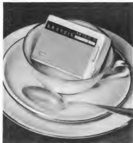
Bild 3. Der kleinste zur Zeit im Bundesgebiet gefertigte Taschensuper Grundig-Solo-Boy wiegt 145 g und hat die Abmessungen 78 \times 54 \times 25 mm
