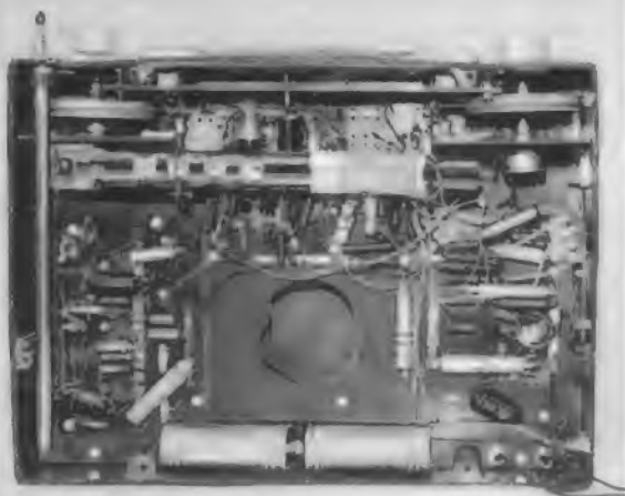
Bild 3. Blick in das Gerät bei entfernter Lautsprecherwand. Links Zf-Verstärker, unterhalb des Drucktastensatzes die Mischstufen, rechts Nf-Verstärker und Umschalter bei Kopfhöreranschluß
