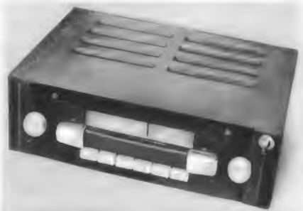
Bild 1. Frontansicht des liegenden MW/KW-Empfängers. Links Lautstärkeregl., in der Mitte Trogegriff und Drucktastensatz (Funktionen von links nach rechts: Ausschalter, Tonblende, MW, KW-I, nicht beschaltet, KW-II), rechts Abstimmung und Stabantenne
