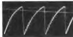
Bild 6. Oszillogramm der Sägezahnswingungen
