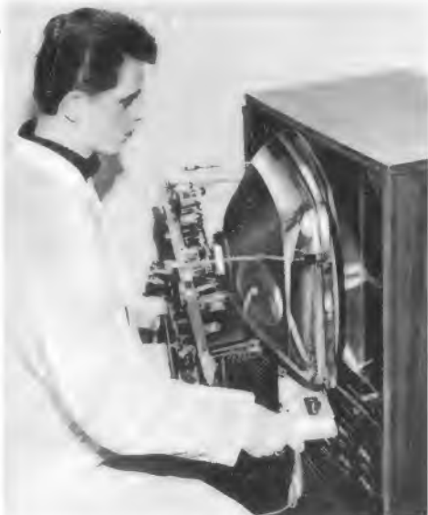
Chassis und Bildröhre können leicht aus dem Schrank herausgenommen und in die Werkstatt transportiert werden (Telefunken FE 24 S)
