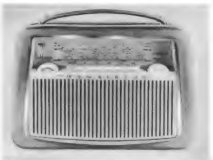
Bild 2. Pinguin U 61 de Luxe von Akkord-Radio – der erste Reisesuper mit Abstimmautomatik auf UKW
