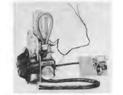
Bild 2. UHF-Umrüstatz Fese sch 10a für Luxusempfänger des Baujahres 1959/60 mit Grob/Fein-Antrieb seitlich am Gehäuse
