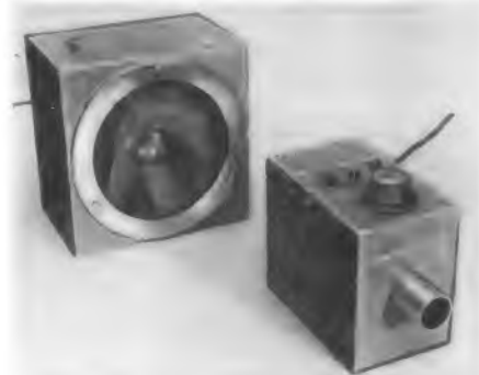
Bild 1. Lichtsender (links) und Lichtempfänger bzw. Licht-Relais (rechts). Im Betrieb stehen sich die beiden Geräte so gegenüber, daß das Licht des Senders genau in den Rohrstutzen des Licht-Relais fällt
