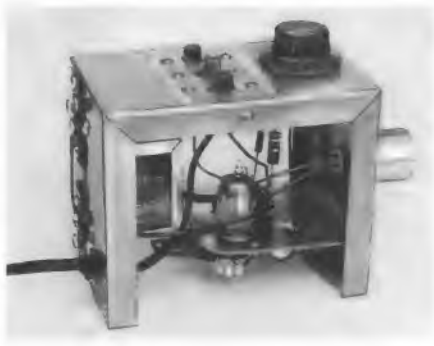
Bild 4. Die einfache Verdrahtung des Gerätes
