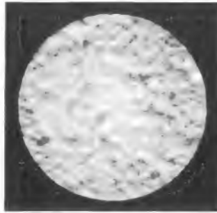
Bild 3. Ausschnitt einer ebenen Katodenoberfläche mit geringer Rauigkeit. Die Aufnahme wurde unter dem Mikroskop mit 40facher Vergrößerung bei schrägem Lichteinfall (Winkel 30°) gemacht.
