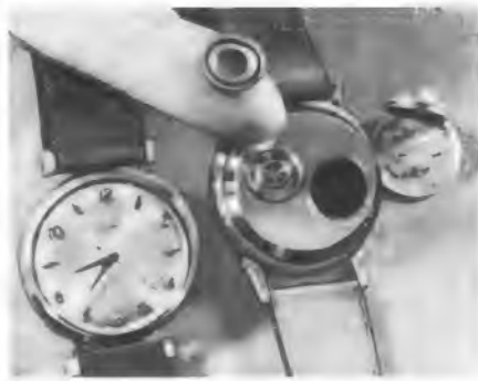
Bild 1. Armbanduhr mit Transistor-Antrieb. Rechts die geöffnete Rückseite der Uhr beim Auswechseln der Batterie. Die auf der Fingerkuppe sichtbare Batteriezelle hält die Uhr 12 Monate im Betrieb
