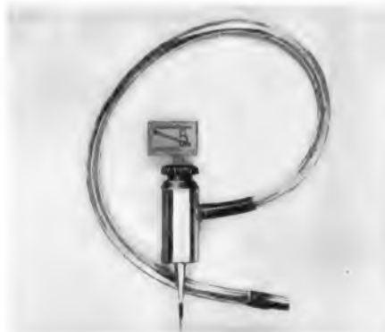
Bild 2. Tastkopf mit Betriebsartenschalter und Abschirmkabel
