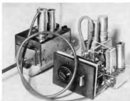
Bild 1. Universal-UHF-Einbauteil mit Hilfs-Zf-Stufe (rechts), gekoppelt mit einer Aufblaskappe auf die Misch/Oszillatorröhre des VHF-Kanalschalters (links)
