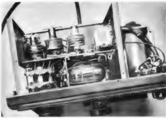
Bild 6. Geöffnete Hf-Kammer mit Spulenträgerplatte, Röhrenfassungsträger und Bereichschalter
