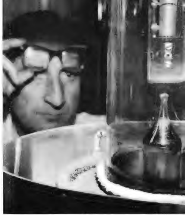
Bild 7. Blick in eine Germanium-Ziehapparatur. Man erkennt im Glasschutz-Zylinder die Germaniumschmelze, aus der mittels eines Impfkristalls der Einkristallstah rotierend mit einem festgelegten Vorschub gezogen wird
