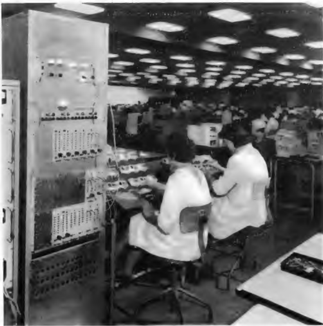
Bild 6. Ein selbst hergestellter Prüfstand zur halbautomatischen Prüfung der elektrischen Werte der fertigen Transistoren und zu deren Sortierung
