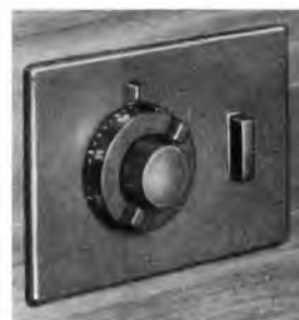
Bild 3. Blick auf die Frontplatte eines eingebauten Universal-UHF-Einbauteiles mit Grob-Feinabstimmung und Drucktaste für die Umschaltung VHF/UHF
