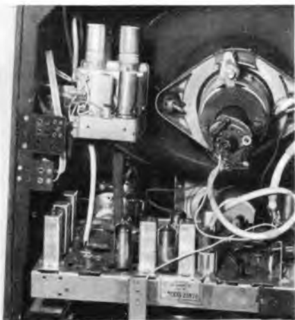
Bild 2. Grundig-Fernsehempfänger Modell 235 (Jahrgang 1956) mit eingesetztem UHF-Einbauteil
