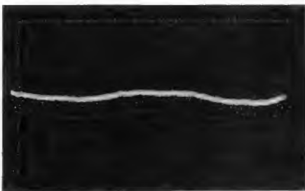
Bild 7. Oszillogramm der Brumm- und Rauschspannung des Hauptverstärkers bei linear eingestelltem Frequenzgang
