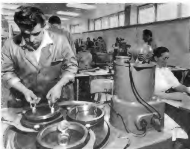
Bild 4. Saal mit Läpp-Maschinen zum Planschleifen von Kristallscheibchen
