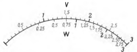
Bild 3. Teilung des gleichen Skalenbogens linear und logarithmisch
