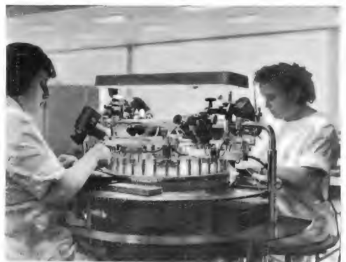
Bild 5. Kontaktieren von Emitter und Kollektor der Transistorsysteme mit verzinnnten Zuführungsbändchen. Diese Arbeiten können ebenso wie die meisten anderen Arbeitsgänge bei der Transistormontage nur mit dem Binocular-Mikroskop ausgeführt werden
