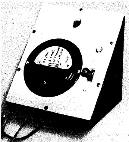
Bild 8. Bedienungskästchen mit Richtungs-anzeige-Instrument, Wendeschalter (rechts), Signallämpchen (darüber) und Richtungs-Kontrolltaste (oben)
