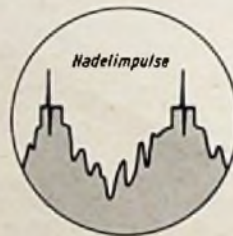
Bild 1. Das Oszillogramm des fehlerhaften Zeilenaustastimpulses an der Bildröhre
