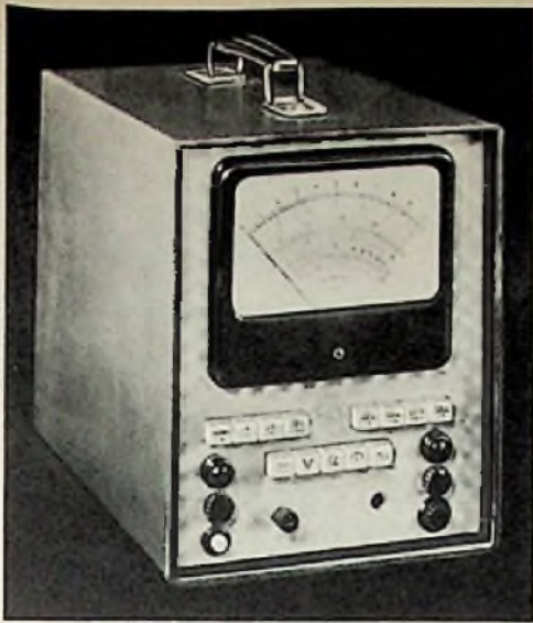
Bild 1. Elektronisch gesteuertes, vollautomatisches Röhrenvoltmeter
