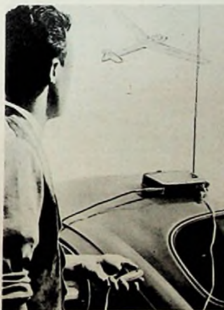
Bild 1. Die Teleskopantenne des Senders kann bis zu 90^{\circ} abgewinkelt werden, so daß man den Sender z. B. auf das Autodach legen und mit der Fernaste bedienen kann. Das zweite Kabel des Senders ist hier zur Stromversorgung an die Autobatterie (Steckdose) angeschlossen
