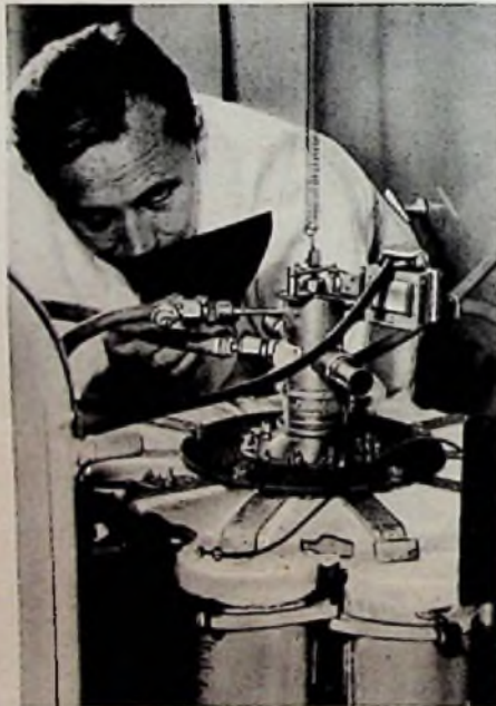
Kondensatorenatterie mit Versuchsaufbau zur Verschmelzung von Wasserstoffkernen
