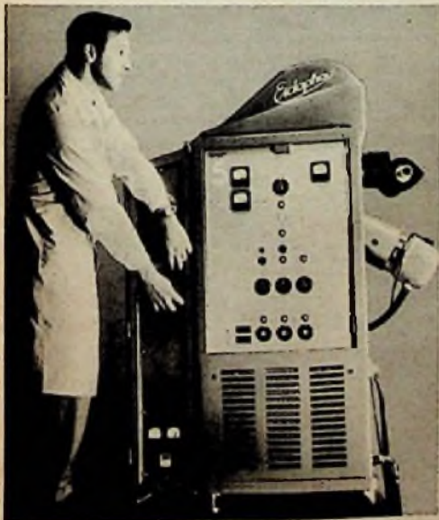
Ein kaum mannshohes Schrankgestell enthält die gesamte Eidophor-Anlage. Sie kann im Vortragsaal selbst aufgebaut werden
