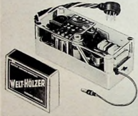
Bild 4. Der kleine, nur 120 Gramm wiegende Empfänger ist wie der Sender bis zu 60° C temperaturunempfindlich
