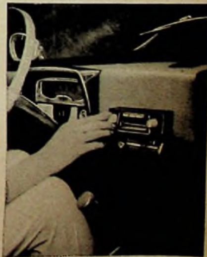
Bild 2. Das Gerät wird im Kraftwagen in eine fachartige Haltevorrichtung eingeschoben und dabei automatisch an die Fahrzeugantenne, die Bordbatterie und gegebenenfalls an einen größeren Wagenlautsprecher angeschlossen
