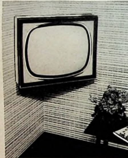
Der Ecken-Fernsehempfänger. Das Bild stellt den Philco-Fernsehempfänger Modell 1021 dar, über den wir in der FUNKSCHAU 1959, Heft 21, Seite 512 berichteten. Seine dreieckige Grundfläche ist so gestaltet, daß er sehr raumsparend in eine Zimmerecke gehängt werden kann
