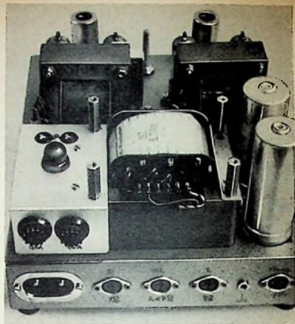
Bild 9. Rückansicht des Endverstärker-Chassis
