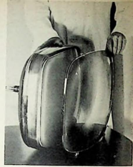
Bild 3. 110°-Bildröhre und Kunststoff-Schutzscheibe
