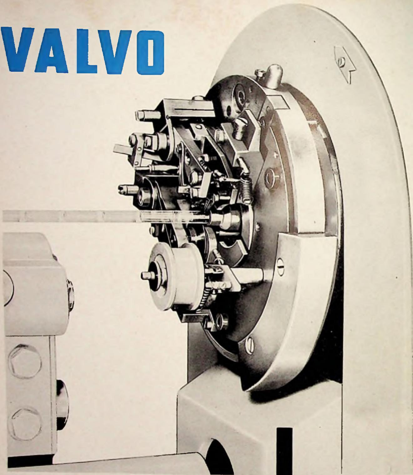
Für die Fertigung von **VALVO RÖHREN** werden zahlreiche schnelllaufende, moderne Präzisionsmaschinen verwendet. Als Beispiel ist hier ein Gitterwickelautomat abgebildet, der mit verblüffender Exaktheit in Sekundenschnelle »Gitter« für Elektronenröhren wickelt. Solch eine Maschine kann in einer Stunde bis zu 400 Gitter mit jeweils 80 Windungen liefern.
