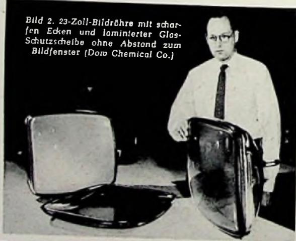
Bild 2. 23-Zoll-Bildröhre mit scharfen Ecken und laminiertes Glas-Schutzscheibe ohne Abstand zum Bildfenster (Dow Chemical Co.)
