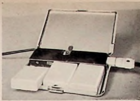
Bild 11. Innenansicht des Modelles von Bild 10. Zum Betrieb dienen drei Rulog-Zellen
