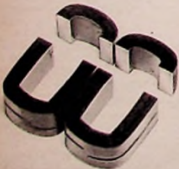
Bild 2. Der aus Texturblech gewickelte Netztransformator nach der Trennung
