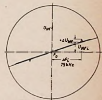
Bild 10. Wie bei Bild 9, jedoch bei Modulation mit Störimpulsen veränderlicher Amplitude an den Enden und in der Mitte des Aussteuerbereiches
