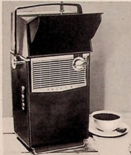
Philco brachte im Juni den ersten batteriegespeisten, wirklich transportablen Fernsehempfänger mit 21 Transistoren heraus
