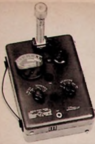
Bild 2. Schallpegelmessgerät Typ 1551-B mit aufgestecktem Mikrofon (General Radio Co.)
