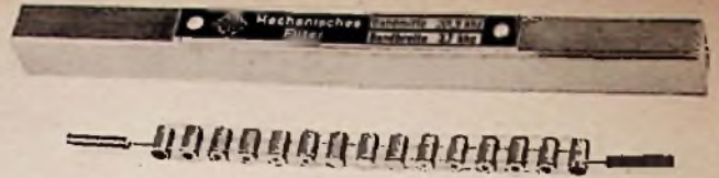
Bild 10. Mechanisches Filter mit 15 Torsionsschwingern. Oben das luftdicht verlötete Gehäuse (Länge etwa 160 mm), unten der Schwingkörper
