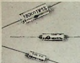
Bild 8. Keine Rollkondensatoren, sondern Präzisions-Schichtwiderstände im Keramikrohr von Steatit-Magnesia
