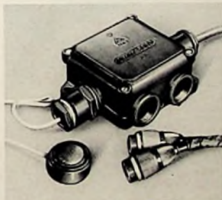
Wasserdicht gekapselter Vorverstärker für Tonaufnahmen von Wasservögeln in freier Wildbahn
