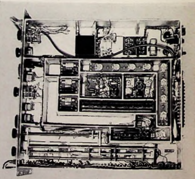
Bild 4. Ein Chassis aus Metallguß spricht für die Stabilität und Dauerhaftigkeit des Gerätes, aber auch für gute Abschirmung. Sie wird durch die Unterteilung in einzelne Kammern bewirkt. Man erkennt die Gruppenbauweise, die Reparaturen erleichtert
