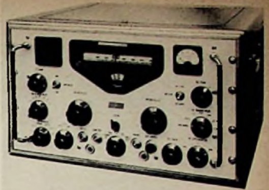
Bild 1. Gesamtansicht des Empfängers Racal RA 17. Rechts Hf- und Nf-Regler, links Bedienungsknöpfe des 2...3-MHz-Empfangsteils. Der linke große Knopf gehört zur Linear-skala (Kilohertz-Einstellung), der rechte große Knopf zur Kreisskala (Megahertz-Einstellung)
