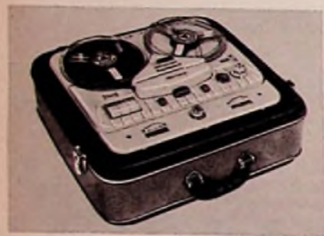
Bild 1. Das Magnetophon 85 Stereo. Es besitzt zwei Geschwindigkeiten 9,5 und 19 cm und einen Frequenzgang von 30...20 000 Hz bei 19 cm/sec Bandgeschwindigkeit. Das Gerät ist neben einkanaliger Aufnahme/Wiedergabe auch für stereofone Wiedergabe eingerichtet. Es verfügt über zwei unabhängige Transistor-Stereo-Vorverstärker
