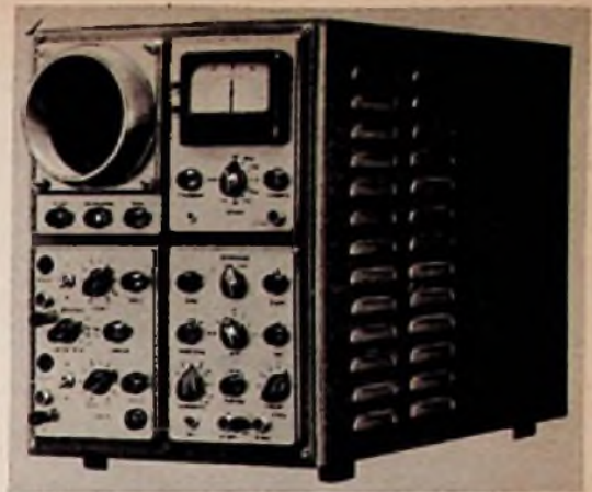
Bild 1. Gesamtansicht des Kienzle-Oszillografen S 800. Zweckentsprechend ist die Teilung der Frontplatte in vier Bedienungsfelder für den Y-Verstärker, den Zeitblenkteil, die Bildröhre und für die Zeit- und Spannungsmessung
