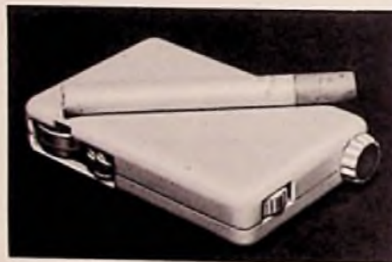
Bild 1. Größenvergleich zwischen dem Transistor-Taschenempfänger und einer Zigarette
