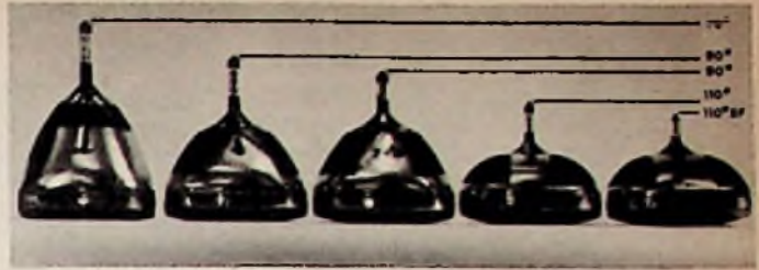
Bild 1. Größenvergleich zwischen Fernsehbildröhren mit verschiedenen maximalen Ablenkwinkel des Elektronenstrahles
