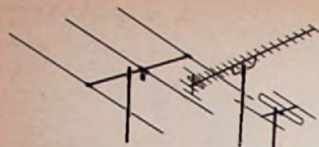
Bild 4. Größenvergleich von Fernsehantennen. Links Band I, Mitte Band IV, rechts Band III
