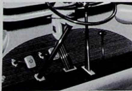
Gegen Zugluft und Kälte ist alles getan: Fußhebelwerk mit Filz- und Gummistulpen, Türen mit Moosgummi abgedichtet und Karosseriewände luftdicht verschweißt.
