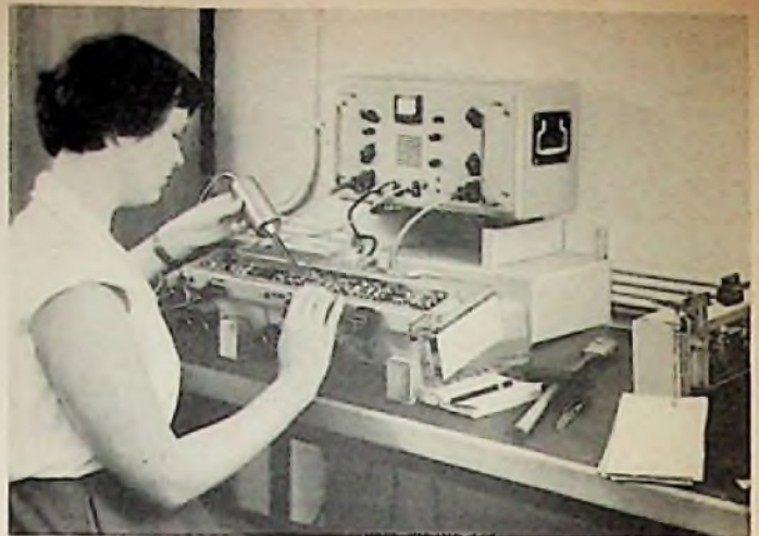
Bild 4. Anwendung des Kontaktfehlersuchgerätes mit Tastkopf zum Orten von Wackelkontakten
