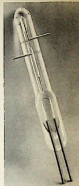
Bild 1. Thermo-Gasdruckrelais von Telefunken. Unten ist der Heizfaden zu erkennen; beim Durchschicken eines Stromes erwärmt er das ihn umgebende Stickstoffgas. Es dehnt sich aus und treibt den Quecksilberfaden hoch, so daß dieser die beiden seitlich eingeschmolzenen Kontakte verbindet
