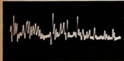
Bild 3b. Ausgefilterte Wackelkontakt - Störspannung nach Bild 3a
