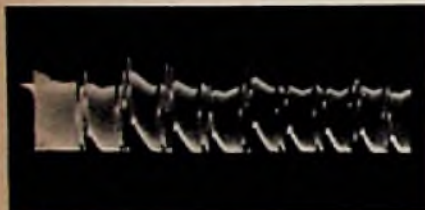
Bild 3a. Oszillogramm einer durch Kontaktfehler modulierten Prüffrequenz
