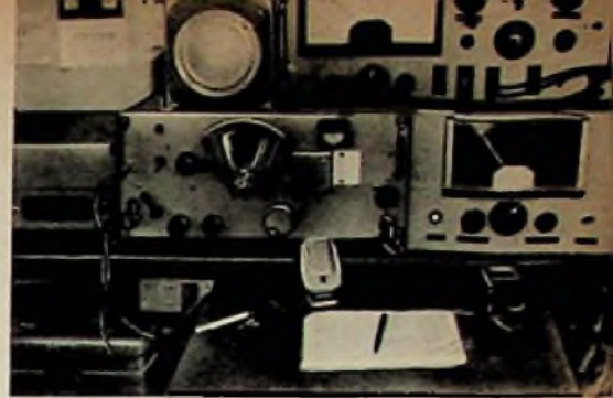
Bild 1. Die KW-Station des Verfassers. Unten links der Empfänger BC 348, rechts daneben der beschriebene Band-Converter, darüber der Amateursender nach FUNKSCHAU 1955, Heft 22
