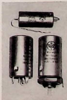
Bild 4. Klein-Elektrolytkondensatoren der Firma Zeh. Links: Doppelkondensator 2 x 32 µF zum Einlöten in gedruckte Schaltungen, Minuspol vom Gehäuse isoliert. Rechts: 2 x 50 µF, 350/385 V. oben: 500 µF, 12/15 V
