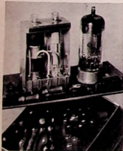
Bild 9. Die Vogt-Kleinbandfilter wurden durch Einzelkreise und achsenparallele Aufbauten ergänzt. Alle Filteraufbauten sind auch für gedruckte Schaltungen lieferbar. Für die Befestigung der Abschirmbecher auf der gedruckten Schaltplatte sind Rastfedern vorgesehen.
