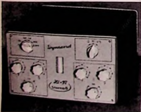
Bild 15. Hi-Fi-Stereoverstärker „Dynacord Stereo 8“. Die Eingangsstufe kann als Tongenerator betrieben werden, um das Einpegeln der Kanäle zu erleichtern
