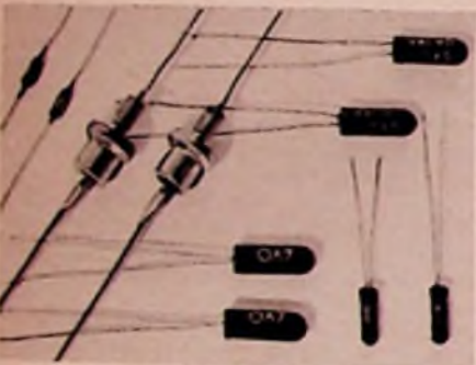
Bild 13. Valvo-Halbleiterdioden; von links nach rechts Silizium-Flächendioden OA 200, Silizium-Leistungsdioden OA 210 und OA 214, Germanium-Golddrahtdioden OA 7 und OA 9, Germanium-Fotodiode OAP 12
