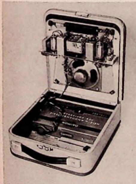
Bild 3. Innenansicht; im Unterteil die kombinierte Heiz-Anoden-Batterie, Chassis und Lautsprecher sitzen an der hochgeklappten Frontplatte
