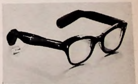
Bild 10 Der gesamte Verstärker in der Omnitron-Hörbrille HB 2 ist in dem keulenförmigen Ansatz links untergebracht; die Trennfuge wurde zur Deutlichkeit übertrieben dargestellt
