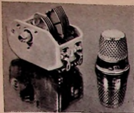
Bild 6. Valvo-Zweifachdrehkondensator für Kleinstempfänger
