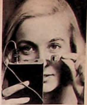
Bild 4. Dynamisches Knopflochmikrofon von Sennheiser für den Reportagesender Mikropoort
