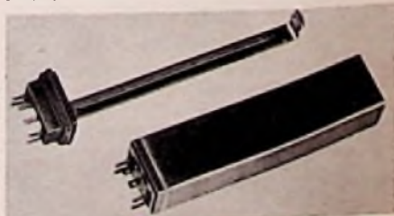
Bild 11. Das neue Siemens-Resonanzrelais, dargestellt über die Fassung mit dem Halteblech
