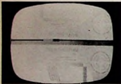
Bild 1. In der Mitte zwischen zwei Bildern kann der schwarze Austastbalken mit dem Bildsynchronisierimpuls sichtbar gemacht werden
