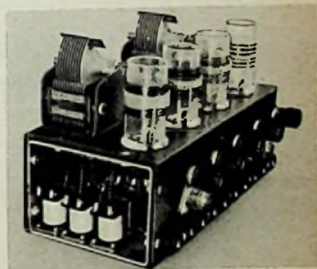
Bild 5. Die Anordnung der Umschaltrelais geht aus der Seitenansicht hervor. Im Vordergrund die Schwingkreisspule für das 80-m-Band
