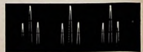
Bild 7. Die drei mittleren Impulsspitzen während einer Zeilenperiode mit dem erhöhten Austastimpuls, der den Abstimmmanzeigestreifen erzeugt
