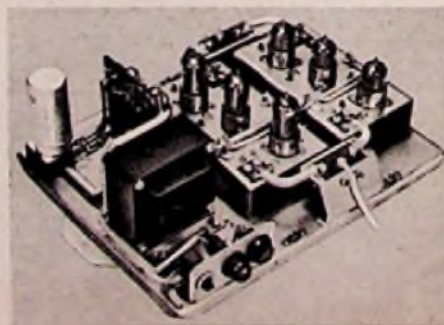
Antennenverstärker für KML, UKW, Band I und Band III für 50 Teilnehmer
