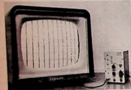
Bild 1. Der transistorisierte Bildmuster-generator (rechts) erzeugt das auf dem Bildschirm sichtbare Muster
