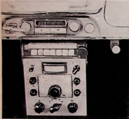
Bild 1. Im Kraftwagen eingebaute Sende/Empfangsanlage für das 80-, 40-, 20-, 15- und 10-m-Band mit Conoerter als Vorspann für den Autosuper (A. Wittmann, DL 1 HY)
