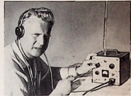
Bild 4. Sender-Empfänger für das 144-MHz-Band zum Betrieb aus Batterien (E. Schäfer, DL 3 ER)
