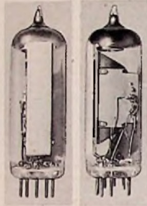
Bild 1. Magisches Band EM 84; links: Vorderansicht, die Leuchtmasse befindet sich direkt innen auf dem Glaskolben; rechts: Seitenansicht
