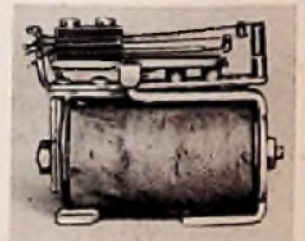
Bild 4. Versuchsmäßige Ausführung eines Remanenzrelais
