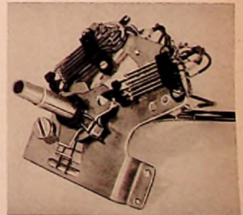
Bild 3. Der Steuerschalter sorgt mit seinen drei Federsätzen für die nötigen Schaltverbindungen für den Such- und Schnelllauf
