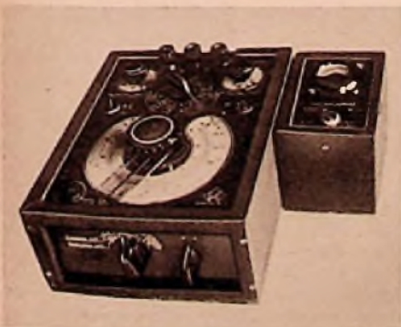
Bild 2. Nach Bild 1 ausgeführte RC-Meßbrücke
