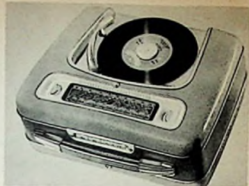
Bild 3. Metz-Babyphon 100. Reisesuper mit batteriebetriebem Plattenspieler für 45 U/min. Für Netzbetrieb läßt sich zusätzlich ein Netzgerät einsetzen. Gerätsersparnis durch gedruckte Schaltung und Fortfall der Schwungmasse des Plattenspielers infolge automatischer Drehzahlregelung. Preis 199 DM
