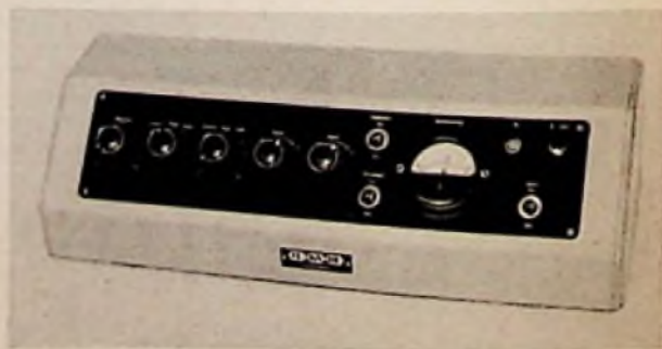
Bild 5. Steuerverstärker von Tekade mit Transistorbestückung
