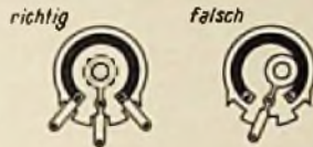
Bild 2. Richtige und falsche Mittelpunktlage des Metallringes. Der besseren Übersicht wegen ist der Schleifer in beiden Ansichten fortgelassen worden
