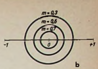
Bild 6. Die Kreise konstanten Reflexionsfaktors (m) in der z-Ebene (Bild 6a) und in der w-Ebene (Bild 6b)
