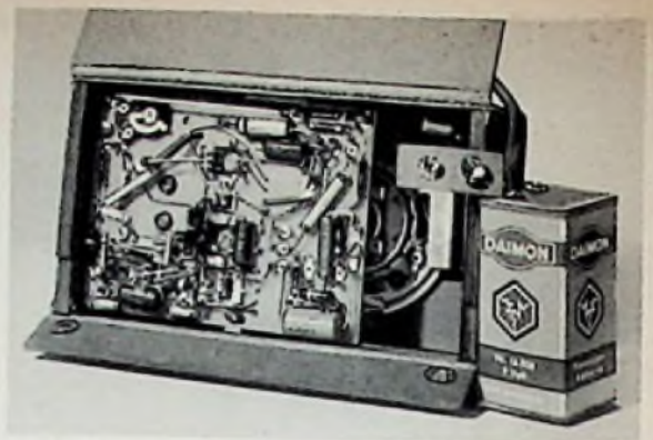
Bild 12. Die Rückseite des Akkord-Taschensupers läßt sich ganz leicht durch Lösen zweier Druckknöpfe aufklappen. Die Montageplatte ist dann frei zugänglich und die 9-V-Transistorbatterie ist einfach auszuwechseln
