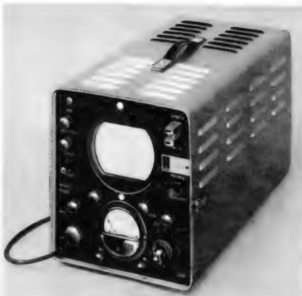
Ansicht des Fernsehantennen-Prüfgerätes SAM 317 W, dessen Schaltung auf der nebenstehenden Seite wiedergegeben wurde (Siemens)
