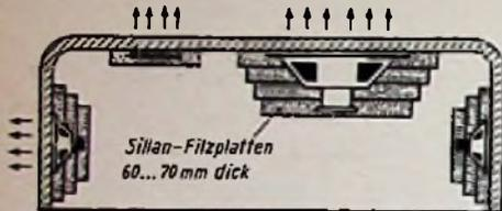
Bild 1. Verbesserung der akustischen Wirkung eines 3-D-Gerätes durch Einbau von Sillan-Platten
