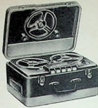
Tonband-Koffergerät mit 5 Drucktasten (Aufn., schneller Vorlauf, Halt, schneller Rücklauf, Wiedergabe) Bandgeschw. 19 cm/sec. Doppelspur. Kombi. Aufn.- und Wiedergabekopf, HF-Löschkopf und Varmagnet. Eingeb. Endstufe mit Kontroll-lautsprecher, Aussteuerung d. Mag. Auge. Autom. Löschsperre. Anschluß für Mikrofon und Tonabnehmer für 350 m LA und 500 m LA-Band. Laufzeit für 350 m 2 x 30 Min. Frequenzbereich 40-12000 Hz. Rd. EF 86, ECC 81, EL 84, EM 11 und Gleichrichter . . . . . DM 398.–
