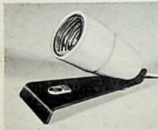
in Verbindung mit Tonbandgeräten. Die Frequenzkennlinie verläuft zwischen 100 und 10 000 Hz praktisch linear. Die abgegebene Spannung beträgt bei niederohmiger Ausführung 0.16 mV/ $\mu$ b (Mikrobar). Das Mikrofon ist tropfenfest ausgebildet und es besitzt ein Stativgewinde zum Aufschrauben auf Bodenständer. Die Maße sind 95 mm Länge und 50 mm größter Durchmesser (Deutsche Philips GmbH, Hamburg 1).
