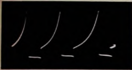
Bild 13. Oszillogramm der Multivibratorspannung am Gitter 1 des Triodensystems
