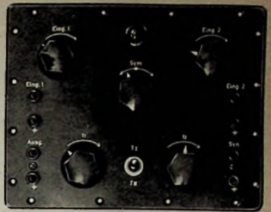
Bild 1. Frontplatte des Elektronenschalters zum gleichzeitigen Schreiben zweier Vorgänge mit einer Einstrahl-Oszillografenröhre
