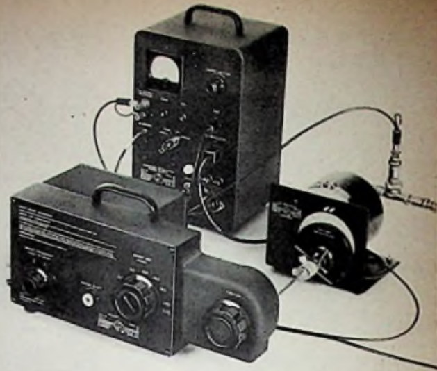
Bild 1. Aufbau eines Meßplatzes mit der Wobbeleinrichtung Typ 1750-A (vorn), dem Amplitudenstabilisator Typ 1263-A (hinten links) und einem Dezi-Meßsender (hinten rechts), dessen Abstimmknopf mit dem Wobblor gekuppelt ist
