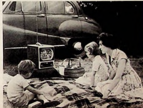
Die Sensation der Radio Show war dieser transportable Fernsehempfänger von Ekco mit 30-cm-Bildröhre, ausgelegt für Band I und III sowie für UKW-Rundfunk in Band II. Stromversorgung: Wechselstromnetz und 12-V-Batterie. Gewicht 12 kg, Preis rund 720 DM
