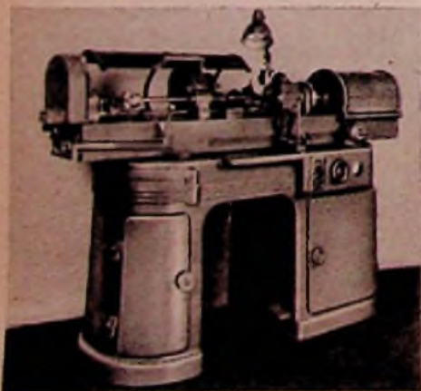
Ein Gitterwickelautomat besonderer Konstruktion, der von der Firma CSF entwickelt wurde und heute, reihenweise gebaut, an Röhrenhersteller verkauft wird
