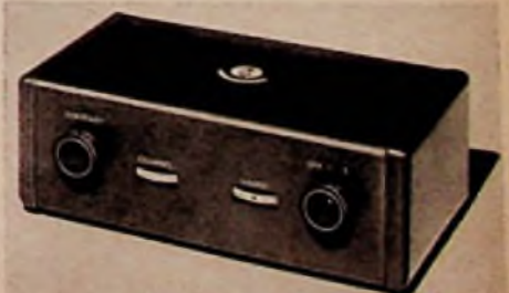
Band-III-Vorsatzgerät für ältere Fernsehgeräte, die nur für Band I ausgelegt sind. Der Vorsatz besitzt eigenen Netzteil (EM1)
