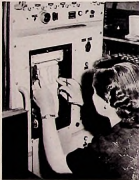
Jede einzelne Mikrofonkapsel wird auf dem Frequenzgang-Schreiber geprüft. Mit Hilfe einer Schablone wird festgestellt, ob die Abweichungen des Frequenzganges innerhalb der zugelassenen Toleranzen liegen
