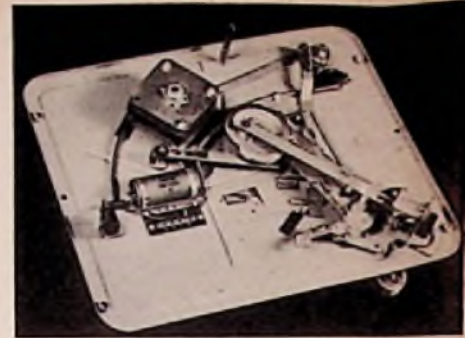
Bild 4. Der einfache Mechanismus des Dokamix-Plattenwechslers von Wumo
