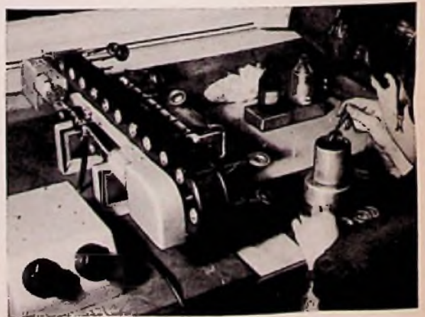
Links: Auf dieser Klebevorrichtung werden die Distanzringe und Anschlußlötzen auf den Ringpolschuh des Mikrofonsystems festgeklebt und bis zum Trocknen zusammengepreßt
