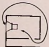
Bild 3. Die geschlossene Rückwand verlängert auch den Weg des Druckausgleichs
