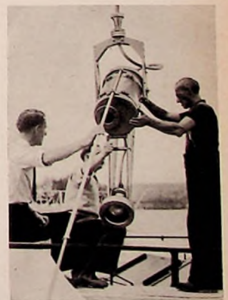
Bild 4. Die Unterwasserkamera wird eingeholt; die vorn sichtbare Stange dient zur Abstandsmessung unter Wasser
