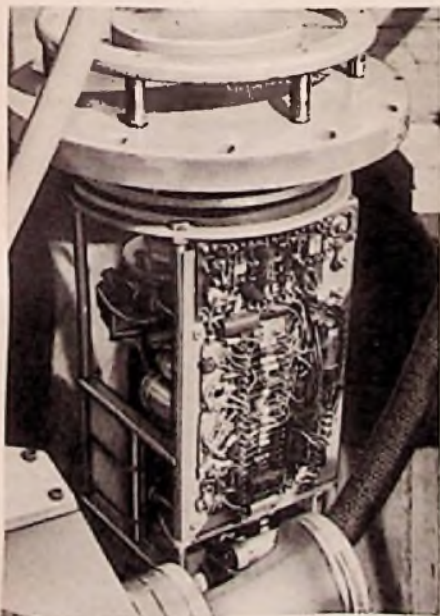
Bild 3. Unterwasserkamera, wie sie zur Suche nach den Trümmern des „Comet“-Flugzeuges benutzt wurde (ohne Gehäuse)
