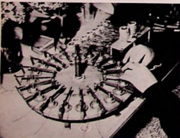
Links: Auf dieser Klebevorrichtung werden die Distanzringe und Anschlußlötzen auf den Ringpolschuh des Mikrofonsystems festgeklebt und bis zum Trocknen zusammengepreßt
