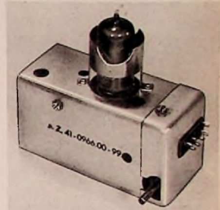
Bild 1. Telefunken-UKW-Eingangs- und Mischteil mit der Doppeltriode ECC 85
