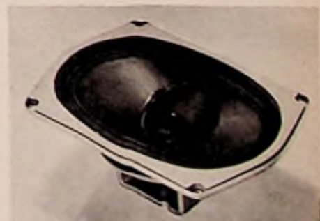
Bild 8. Philips-Duo-Lautsprecher mit abgelenktem Mittelkegel
