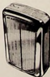
Omniton-Hörhilfe Trans I mit Transistorbestückung
