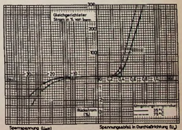
Rechts: Dynamische Strom- und Spannungscharakteristik für eine Platte der Valvo-Selen-Gleichrichter
