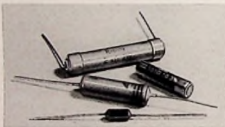
Verschiedene Ausführungen von Resista-Widerständen. Rechts ein kappenloser Spezial-widerstand für Höchstfrequenzen, davor ein tropenfester Widerstand mit Farbbringkenn-zeichnung, ganz vorne ein 0,5-W-Schichtwiderstand mit axialen Anschlußdrähten und da-durch sehr geringen Abmessungen
