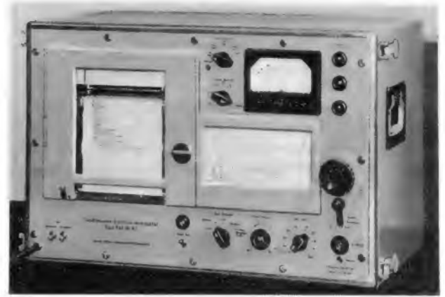
Bild 5. Suchton-Analysator Type FAT 28 R 7 mit Registriereinrichtung
