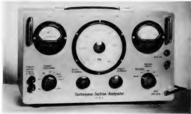
Bild 3. Einfacher Suchton-Analysator der Fa. G. Koller
