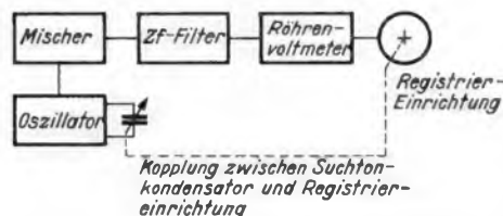
Bild 2. Suchtonanalysator mit Registriereinrichtung
