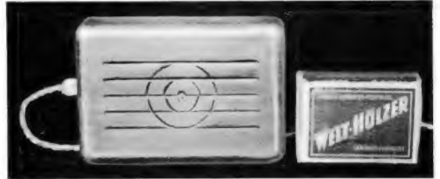
Bild 1. Der Taschenempfänger im Vergleich zu einer Zündholzschachtel
