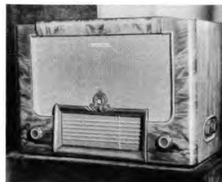
Bild 3. Sowjetischer Großsuper Typ Oktjabr (9 Röhren, 6 Wellenbereiche, 10 Kreise)
