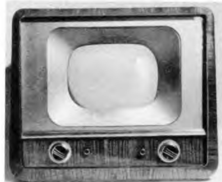
Bild 1. Elbia-Fernsehgerät Helios. Die relativ geringe Bildgröße 18 x 24 cm entspricht einer Diagonale von 30 cm
