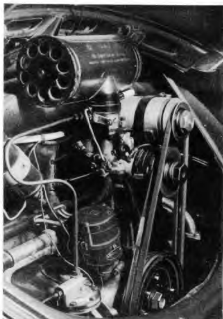
Bild 3. Für den Funkfersprecher muß eine zweite Lichtmaschine in den Volkswagen eingebaut werden
