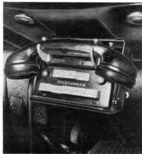
Bild 1. Der Funkfersprecher am Armaturenbrett des Volkswagen
