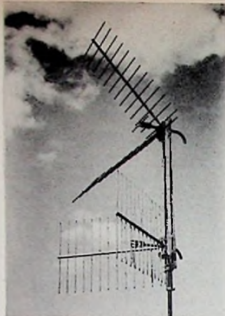
Bild 10. Winkelantenne für Siemens-PPM 6/300-Anlagen. Bandbreite je nach eingesetztem Dipol 280 bis 305 oder 305 bis 328 MHz. Oben Sende-, unten Empfangsantenne
