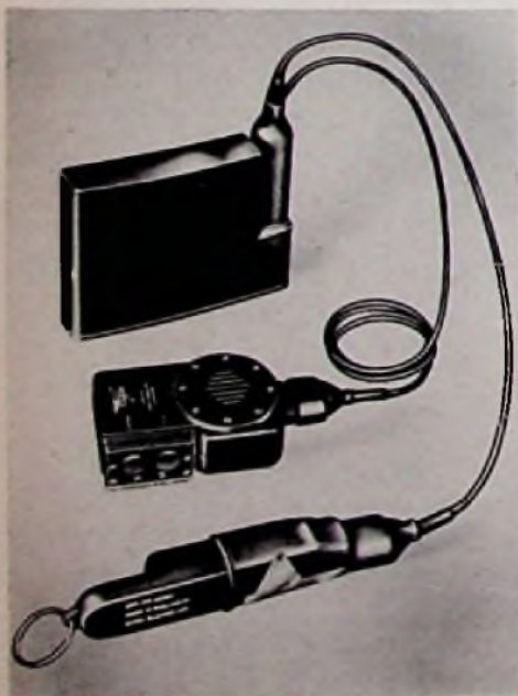
Bild 1. SARAH für Flugzeugbesatzungen. Vorn: etgerollte Bandantenne mit Schutzhülle, in der Mitte: Mikrofon mit Umschalteneinrichtung, hinten: Sende/Empfänger mit Batterietasche
