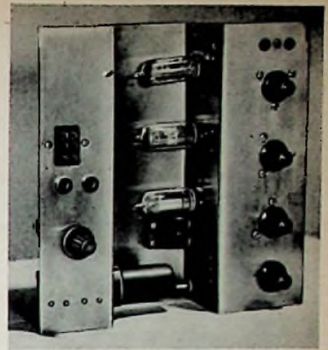
Frontansicht des vollständigen Senders ohne Gehäuse (auf die Seite gestellt)
