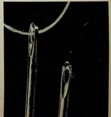
Ein Nylonfaden aus einem Damenstrumpf (links oben) im Vergleich zum Heizfaden in einer Telefonkathodenröhre
