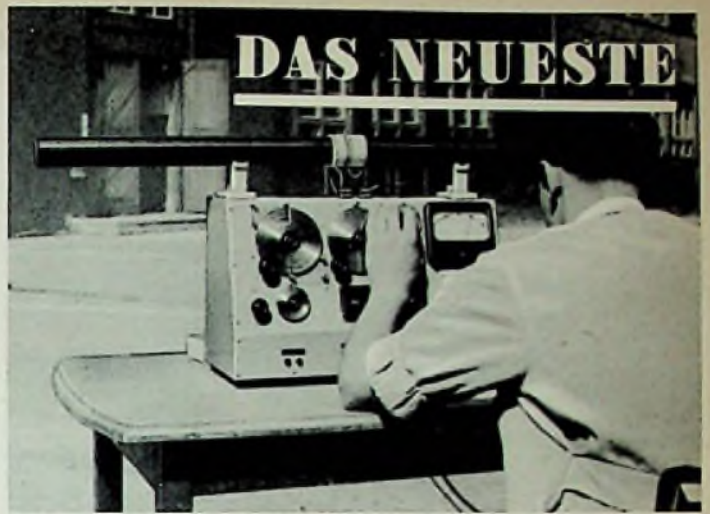
Sonderausführung einer Ferrit-Peilstabantenne. Länge: 1 m, Durchmesser: 50 mm außen, 24 mm innen (Philips)
