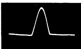
Bild 7. FM-Zf-Resonanzkurve bei übersteuerem Empfänger
