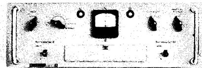
Bild 2. Elektronisches Ablösegerät für automatische Umschaltung auf jenen von zwei Empfängern, der gerade den besseren Empfang ergibt
