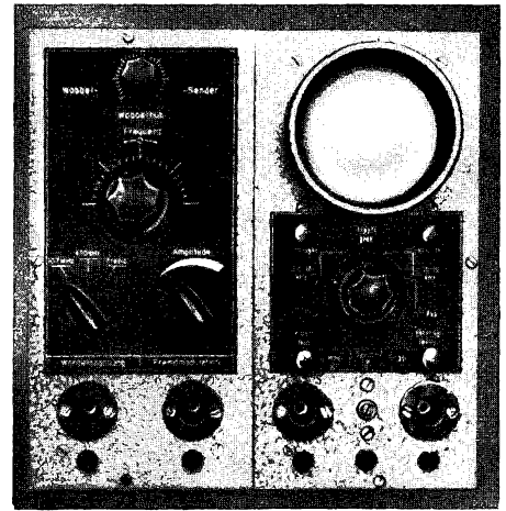
Wobblersender und Kurvenschreiber zusammengeschaltet
