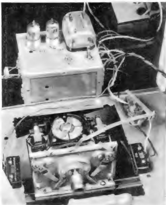
Bild 2. Steuerverstärker und hydraulische Steuereinrichtung an einem Modellfahrzeug angebracht
