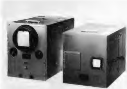
Bild 3. Sichtgerät (links) und Motorwähler (rechts) des elektronischen Fernthermometers
