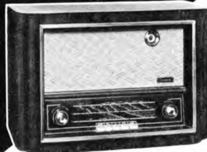
JOTHA- Mercedes 54 Großsuper mit 9 UKW- und 6 AM-Kreisen, 5 Drucktasten, 3 Wellen- bereiche, 8 Röhren, überragende UKW-Leistung durch rauscharme 2-Röhren-Hochleistungs-Vorstufe und Ratio-Detektor, großer 6-Watt-Oval-Konzert- lautsprecher, 5-Watt-Endstufe, Schwungradantrieb, Magisches Auge, geeicht. UKW-Namenskala, kontln. Tonblende, eingebauter Allwellen-Hochleistungs- Dipol, Anschlüsse für Tonabnehmer u. 2 Lautsprecher, reichverziertes, hochglanzpoliertes Edelholzgehäuse 520 x 345 x 250 mm Preis: DM 295.-
