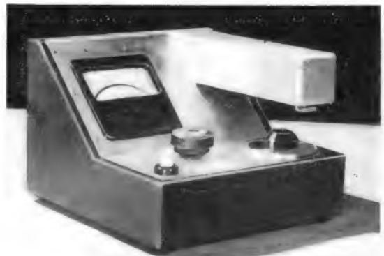
Bild 2. Absorptionsmesser zur Messung von Trübungs- und Farbwerten (Dr. Schneider, Bad Kreuznach)
