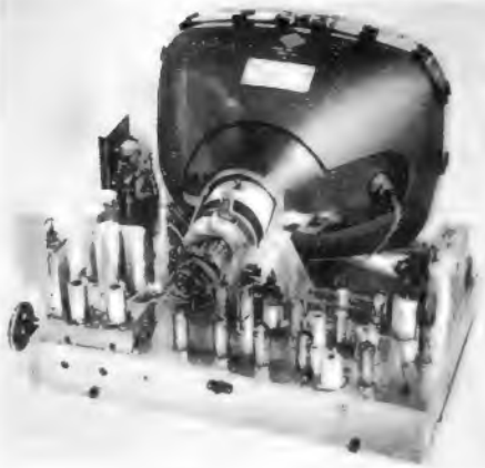
Bild 5. Chassis des Telefunken FE 9. Man beachte den Platz des Kanalschalters (links außen)
