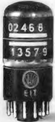
Bild 1. Ansicht der neuen Zählröhre E 1 T
