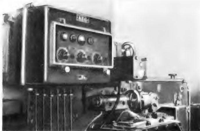
Bild 4. Fotoelektrische Regeleinrichtung für Papier-Verarbeitungsmaschinen (AEG)
