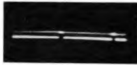
Bild 201. Oszillogramm der Spannung am Anodenwiderstand einer Mischstufe
