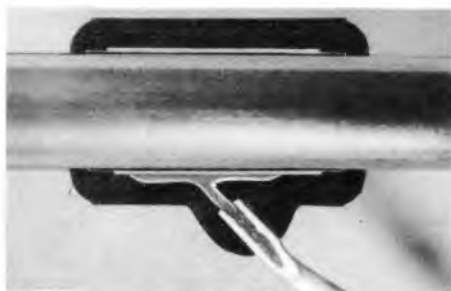
Bild 6. Schnitt durch die Anzapfstelle mit dem Kompensationskondensator
