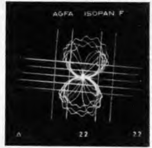
Bild 4. Peilfigur eines Senders, dessen Träger tonmoduliert ist
