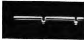
Bild 200. Oszillogramm der Eingangssynchronisierimpulse
