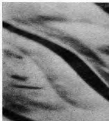
Bild 214. Falsche Zeilenfrequenz und falsche Synchronisierphase
