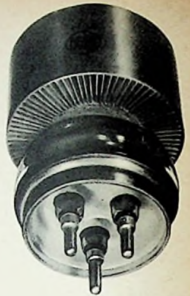
Bild 2. Luftgekühlte VHF-Triode BTL 1-1 für eine Anodenverlustleistung von 1 kW, Höhe 133 mm (Brown Boveri)
