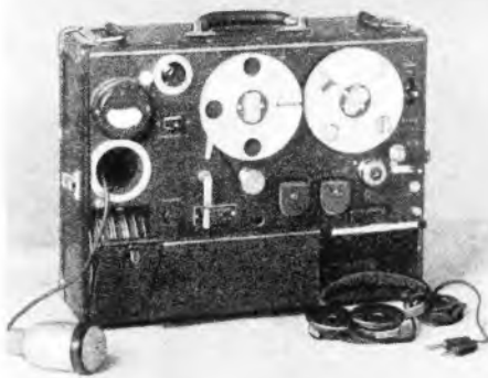
Reportage-Tonbandgerät C des Bayerischen Rundfunks (19 cm Bandgeschwindigkeit) Aufnahme: E. Anker
