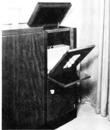
Bild 2. Programmwähler im Schrankbau mit dahinterliegendem Verstärker (Aufnahmen: Siemens & Halske)
