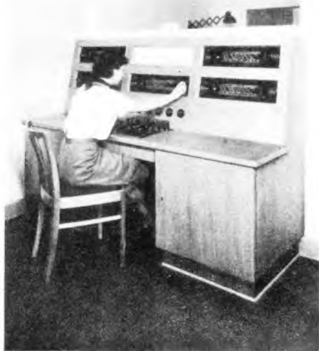
Bild 1. Zentralgesteuerte Rundfunkübertragungsanlage mit fünf Rundfunkempfängern und Zehnplattenspieler
