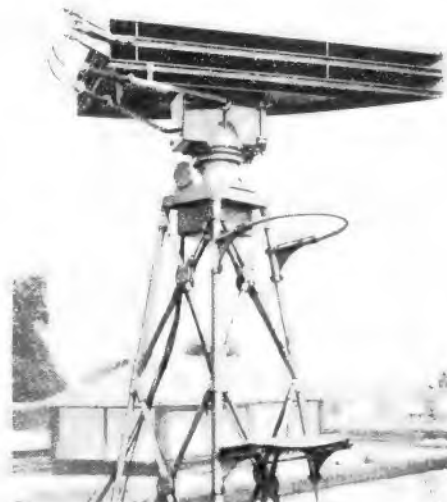
Bild 2. Die Drehantenne der Decca-Meßfunk-Anlage. Besonders kurze Zuleitungen zum unmittelbar darunter gebauten Verstärker vermeiden Störungen und Verluste
