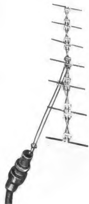
Bild 4. Dipolzeile für \lambda = 10 \text{ cm}
