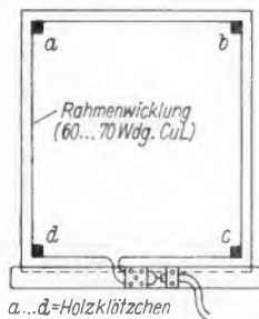
Bild 2. Die Rahmenwicklung wird an der Rückwand eines 18 x 24 cm großen Fotoständers angebracht
