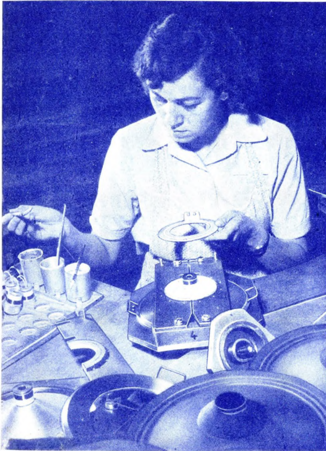
Bei den Geräten der neuen Saison wird der Klangqualität und damit den Lautsprechern ganz besondere Aufmerksamkeit gewidmet. Hier ein Bild aus der Fertigung der Lorenz-Celophon-Lautsprecher. Genau gearbeitete Spannvorrichtungen sorgen für einwandfreie Zentrierung sowohl beim Verkleben der leichten Schwingspule mit der elliptisch gekrümmten Membran als auch beim Aufsetzen der Gewebezentrirmembran und ihrer ringförmigen Halterung.
