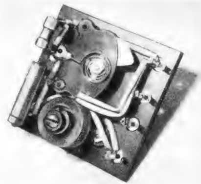
Bild 2. Aufbau des Detektorempfängers nach Schaltung Bild 1 . Links neben dem Drehkondensator sieht man die Germanium-Diode DS 60
