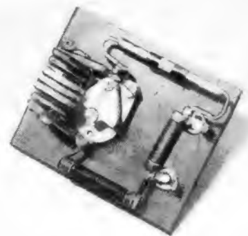
Bild 9. Aufbaubeispiel für den UKW-Detektorempfänger nach Bild 7
