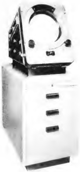
Bild 3. Sichtgerät der Decca-Meßfunk-Anlage. Auf dem Schirm der Braunschen Röhre erscheint das Abbild des Hafens und der darin befindlichen Fahrzeuge (Fotos Telefunken)
