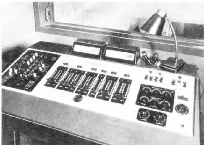
Bild 3. Regietisch mit Reglern, Druckknopfsteuerung für die einzelnen Betriebsarten und Lichtzeiger-Aussteuermessern
