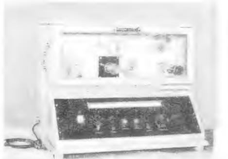
Spannungsprüfgerät für Lackdrähte
