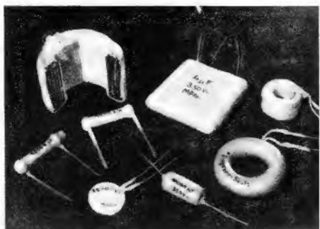
Einzelteile mit Kunstwachs-Überzügen bzw. -Imprägnierungen. Vorn von links nach rechts: Keramik-Rohrkondensator, Scheibenkondensator, Rolkondensator und eine Ringkernspule. Hinten links ein freitragender aufgeschnittener Transformatorwickel (um das Eindringen der Imprägnierung zu untersuchen), davor ein getauchter Widerstand. In der Mitte hinten ein 4- \mu F-Flachwickel und rechts eine Hf-Spulenwicklung (Foto: C. Stumpf)
