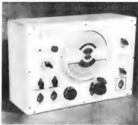
Bild 1. Meßsender mit neun verschiedenen AM- und FM-Bereichen
