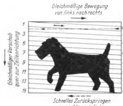
Bild 2. Abtasten eines ebenen Bildes zur elektrischen Übertragung
