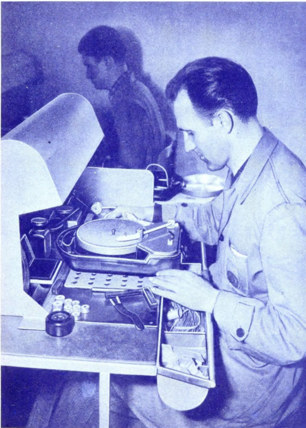
Ein Schlager der Industriemesse Hannover war der neue Plattenspieler-Koffer von Philips mit zwei Geschwindigkeiten (33 \frac{1}{3} und 78 U/min). Höchste Klangtreue vereint sich in ihm mit geringstem Platzbedarf, niedrigem Gewicht und volkstümlichem Preis. - Unser Bild zeigt die Endmontage dieses in einen neuartigen Kunststoff-Koffer eingebauten Plattenspielers in der Berliner Fabrik.
