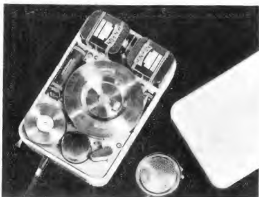
Batteriebetriebenes Taschen-Drahttongerät „Minifon“ der Firma Monske & Co.
