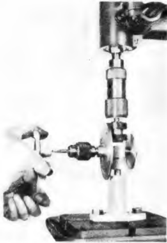
Bild 1. Gewindeschneid-Halbautomat, an einer Bohrmaschine angebracht
