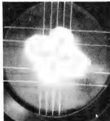
Bild 8. Peildiagramm von zwei gleichzeitig arbeitenden Sendern
