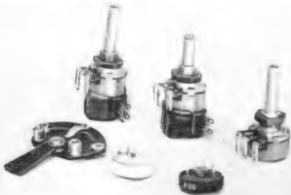
Neue Preh-Bauteile (Vordere Reihe von links nach rechts: Flachregler mit Einstellhebel Nr. 4155, Knopf-Potentiometer, Schlepsschalter Nr. 4216, hintere Reihe von links nach rechts: Preostat-190-Potentiometer mit Autosuper-Drehschalter Nr. 4330, Preostat-190-Potentiometer mit zwei-poligem Deckeldrehschalter Nr. 4293 und Preostat-190-Potentiometer ohne Schalter)
