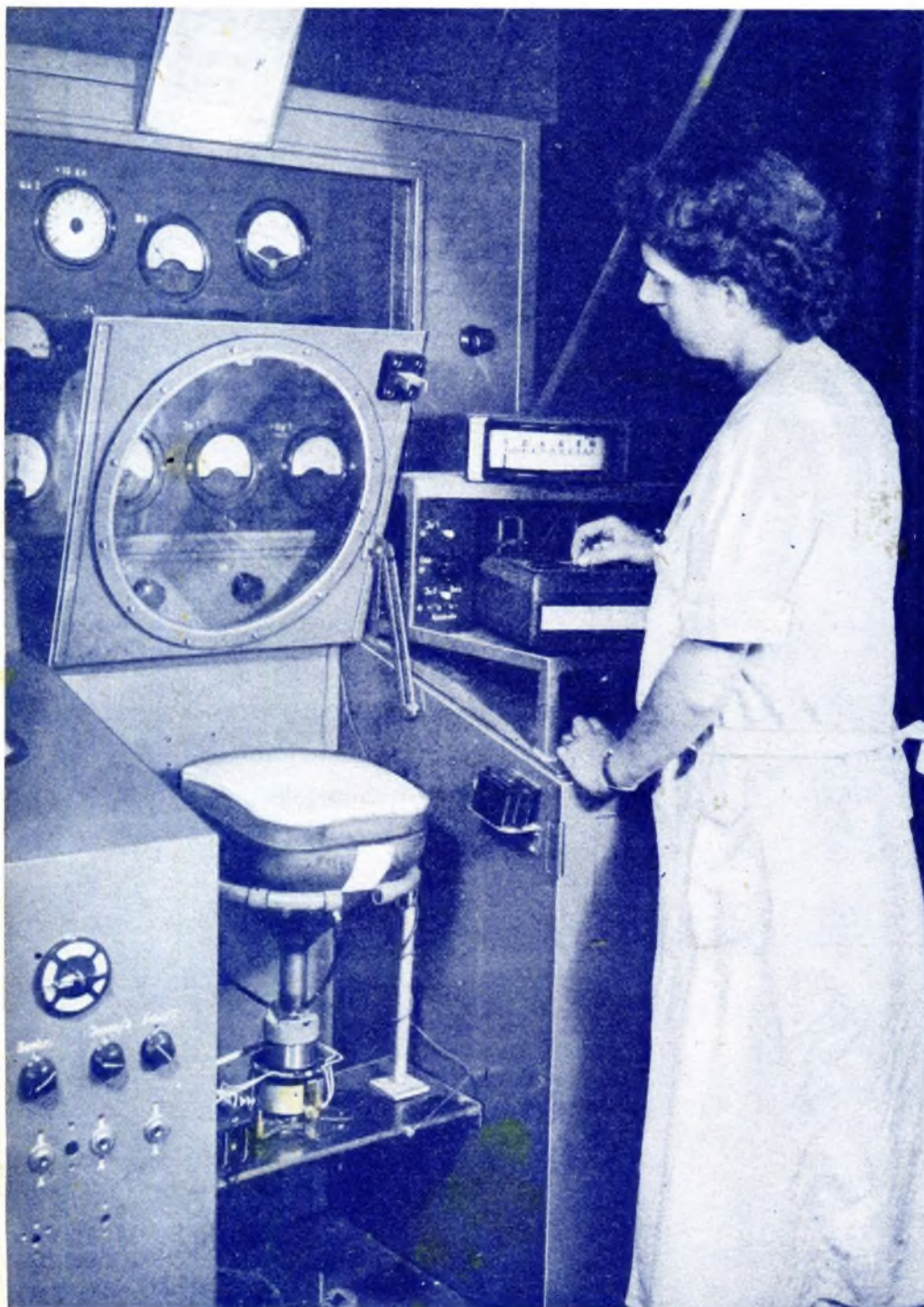
Eine Kontrollstation in der Fertigung der Valvo-Rechteck-Bildröhren in der Radioröhren-Fabrik der Deutschen Philips G. m. b. H. in Hamburg-Lokstedt. Auf diesem Meßtisch wird jede Bildröhre — hier handelt es sich um den Typ Valvo MW 36-22 — auf ihre Schirmhelligkeit sowie Punkt- und Strichscharfe geprüft.
