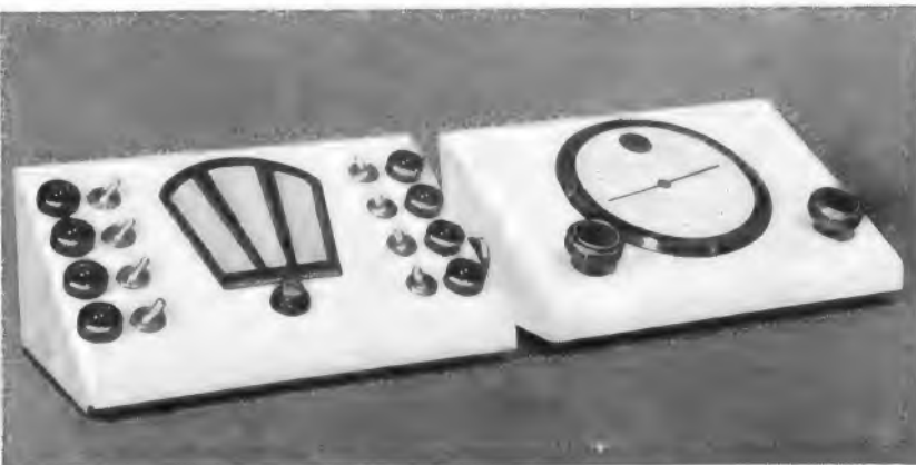
Die Abmessungen der Hauptstelle entsprechen der Größe des Fernbedienungsgerätes „Selecton“, das einen 6-Kreissuper ohne NF-Teil mit Stromversorgung aus dem nachgeschalteten Gerät darstellt. Hauptstelle und Rundfunkzusatz können nebeneinander auf dem Schreibtisch aufgestellt werden, ohne zuviel Raum zu beanspruchen
