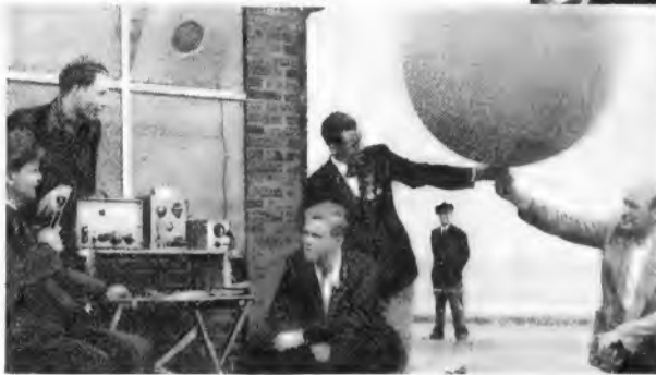
Die 20-Watt-Amateurstation der Firma See-Funk-Nord. Oben befindet sich der Sender. Darunter sieht man den 5-Röhren-7-Kreis-Super für alle Amateurbänder.
