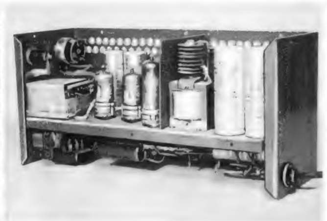
Gesamtchassisansicht des Gegensprechverstärkers. Der Verstärkerteil (links) und der Netzteil (rechts) sind durch eine Abschirmwand getrennt
