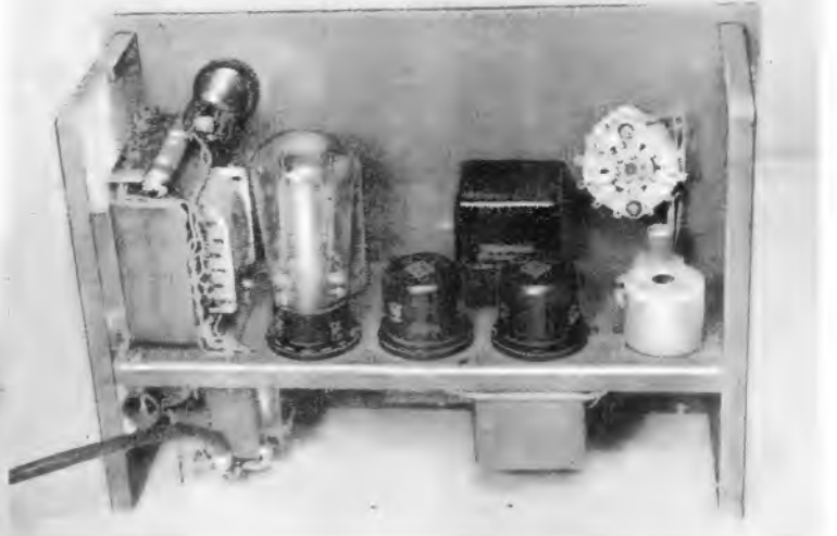
Bild 2. Verdrahtungsansicht mit Abschirmung unter der Montageplatte. Neben der Netzdrossel ist der Hf-Störschutz sichtbar
