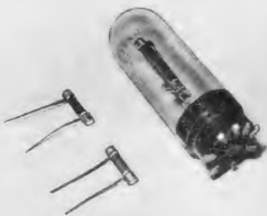
Bild 1. Die neuen Newi-Schutzwiderstände im Größenvergleich zu einer typischen Urdoxröhre
