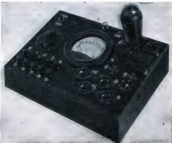
Leistungs-Röhrenprüfer mit Drucktasten, aufgebaut nach dem FUNKSCHAU-Bauplan M 1.
